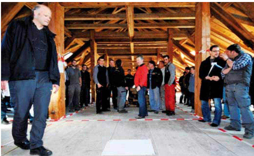
Über hundert Personen nahmen an einer Belastungsprobe im Zeughaus teil. Es ging darum, aufzuzeigen, ob das Obergeschoss eine Nutzlast von 150kg/m 2 aushält. Foto: RF
