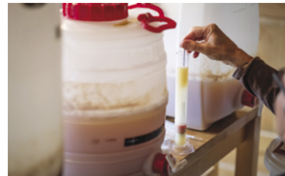
9 Eine Woche später: Die Hefe hatte nun eine Woche Zeit für ihre Arbeit. Als Erstes wird erneut die Stammwürze ermittelt.
