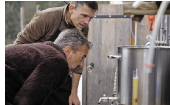
8 Bevor der Bottich zur Gärung auf die Seite gestellt werden kann, muss noch der Stammwürze-Wert gemessen werden.
