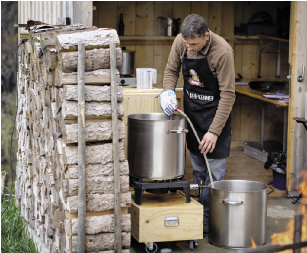
7 Nachdem die Würze eine gute Stunde gekocht hat – dabei wird auch die Hefe dazugegeben – folgt die «Würzklärung». Dabei wird die Würze von den Reststoffen getrennt und in den Gärbottich abgefüllt.
