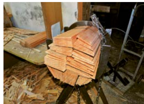
6 Die fertigen Schindeln werden zu handlichen Paketen geschnürt.
