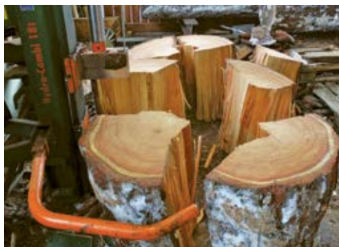
3 Anschliessend werden die Stücke gespalten.
