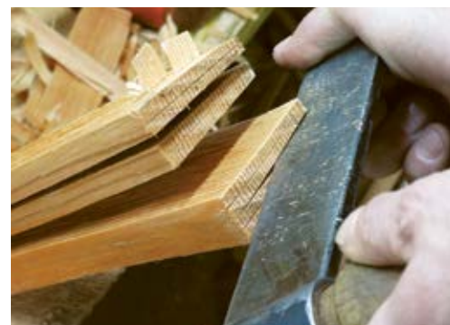
5 Mithilfe des Schindelmessers werden die einzelnen Schindeln abgetrennt.
