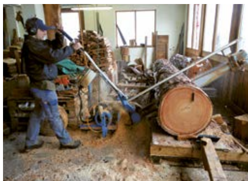
2 Der erste Arbeitsschritt auf dem Weg zu den Graubündner Lärchenschindeln nach dem Fällen: das Zuschneiden der Stämme.
