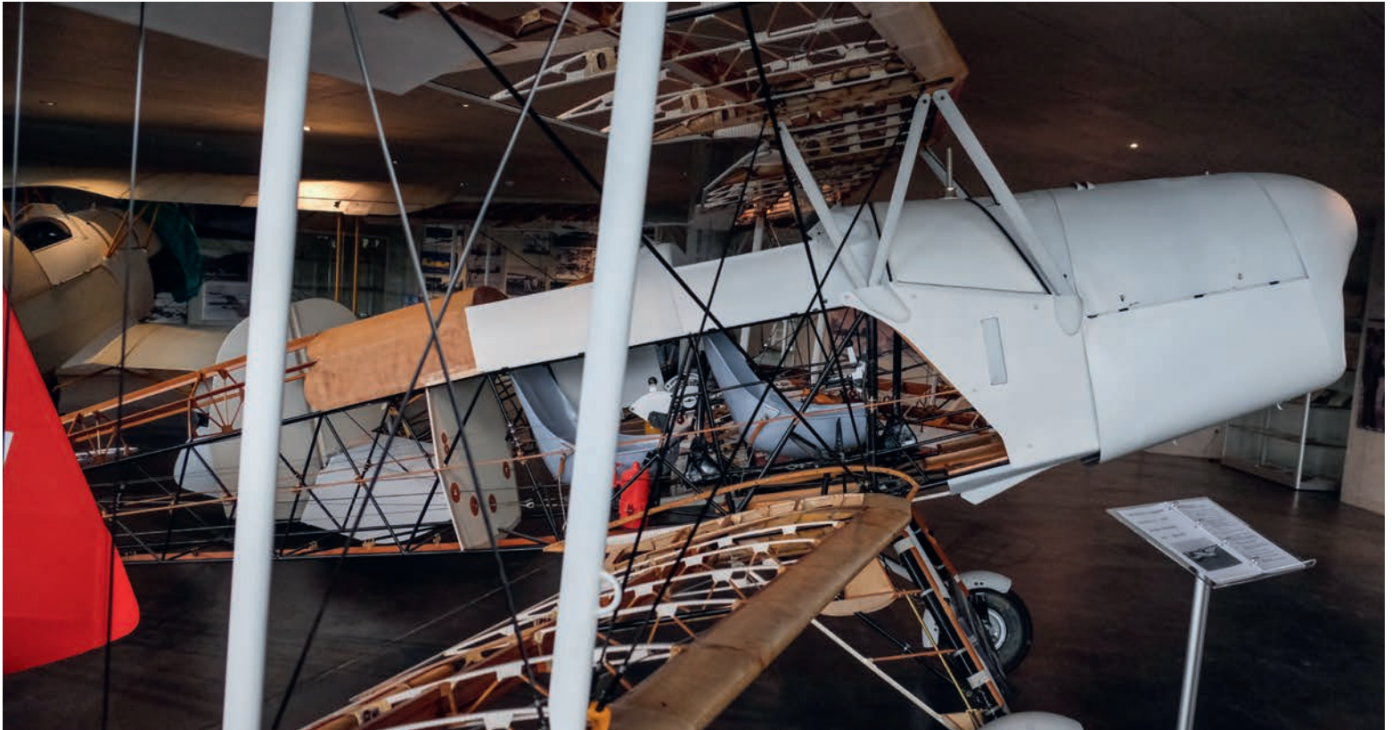
Beim teilweise «entblösten» Bücker 131 Jungmann wird die konsequente Leichtbautechnik gut sichtbar. Foto: tiz
